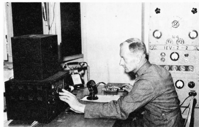
Radiotoiminnan huippua edustava ilmavoimien 500 watin Hellberg-AB-asema ja FBX-vastaanotin toiminassa Lappeenrannassa SA-kuva
