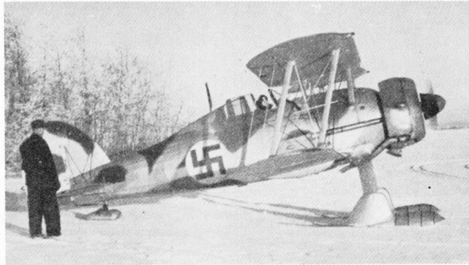
Gloster Gladiator Mk.1 helmikuussa 1940. Suomalaisten käytössä olleen Mk.2:n moottorin teho oli 840 hv ja koneen huippunopeus 410 km/h
