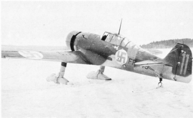
Wasp-Fokkerissa oli toteutettu useita muutoksia, mm. ohjaamon lasitusta oli jatkettu näkyvyyden parantamiseksi
