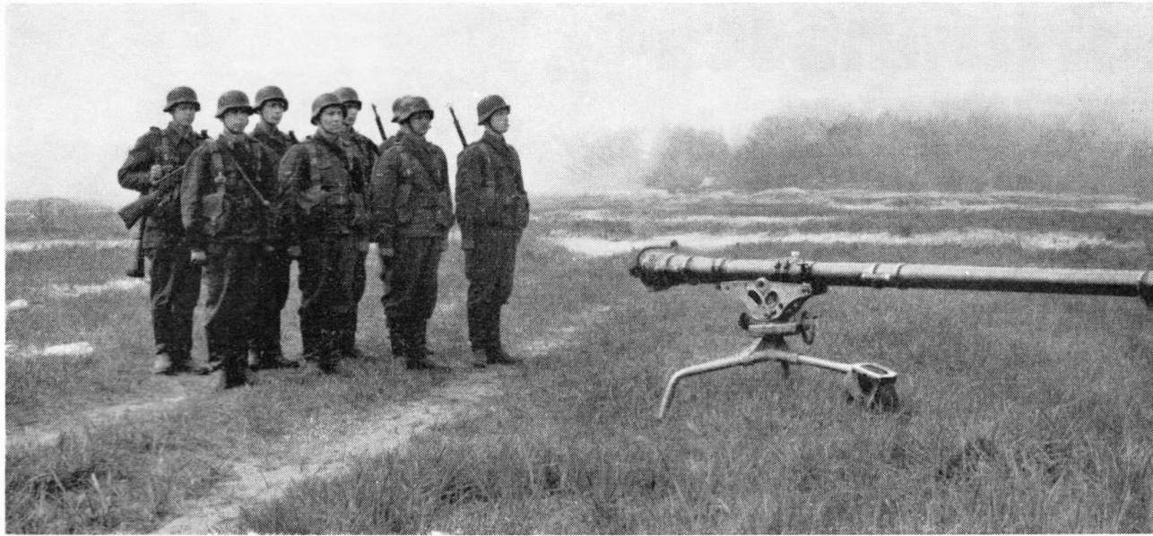
Raskas sinko miehistöineen. Sen onteloammus puhkaisee kaikki tunnetut panssarit suomalaisessa maastossa tavallisesti kysymykseen tulevilta etäisyyksiltä
