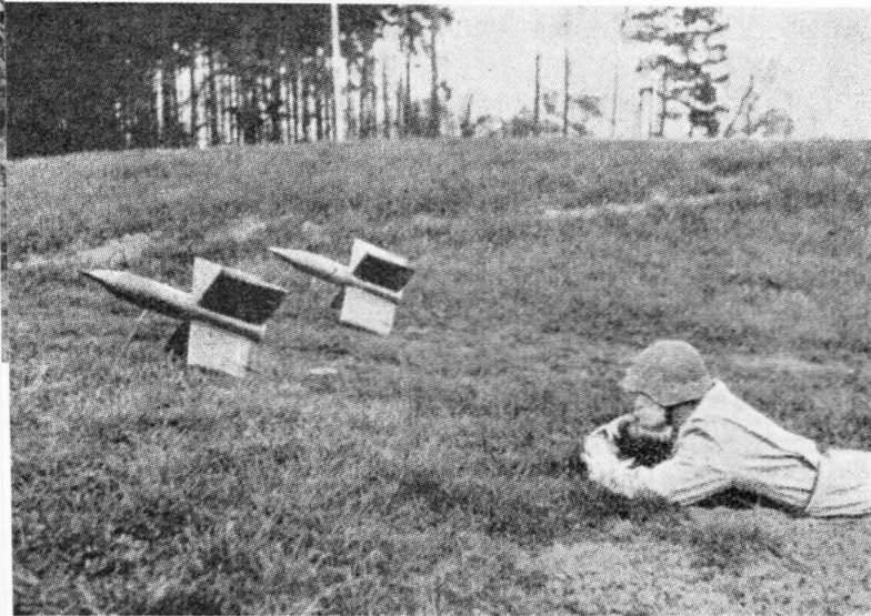
Kevyt sveitsiläinen pst-ohjus Mosquito laukaisuvalmiina. Kantama 1,8 km, paino 12 kg, läpäisee yli 50 sentin panssarin
